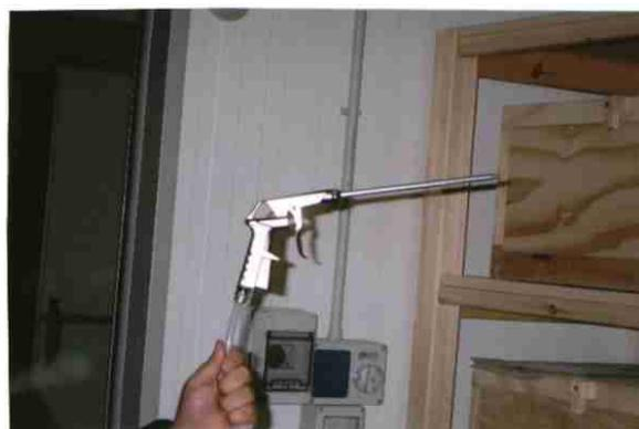
**Erogatore di CO<sub>2</sub> per la raccolta in gabbia**
